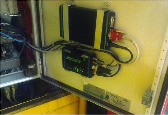
Per la diagnosi a distanza dei dati, le informazioni e i codici di errore presenti sul calcolatore del veicolo vengono letti e analizzati mediante richiesta a distanza. Questi valori vengono trasmessi al servizio tecnico mediante modem (GSM oppure Internet).
