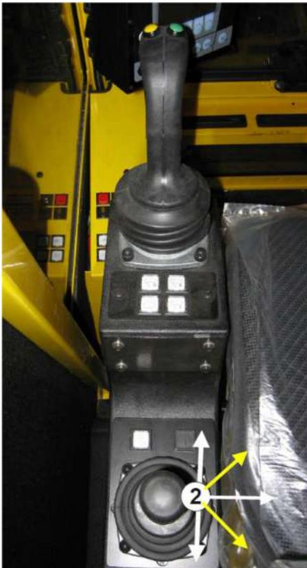
Per trazionare e frenare contemporaneamente, p.es. per le partenze su tratte in salita, spostare il combinatore di comando **2** diagonalmente.
