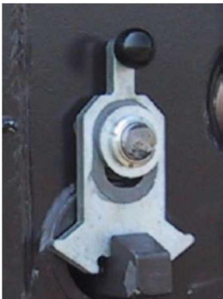
Bloccare meccanicamente i sostegni e controllare il bloccaggio delle sospensioni (allentato).
