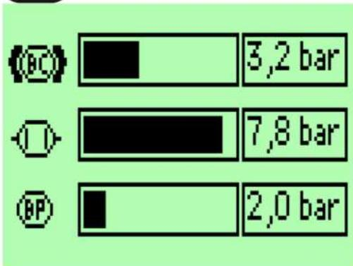
**Indicazione del freno****Linea 1** - Indicazione della pressione del cilindro del freno in bar**Linea 2** - Indicazione della pressione del serbatoio dell'aria in bar**Linea 3** - Indicazione della pressione della condotta principale in bar
