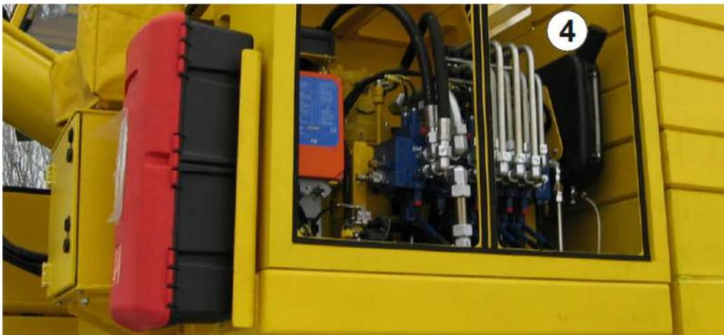
Serbatoio del carburante **4** per il riscaldamento
