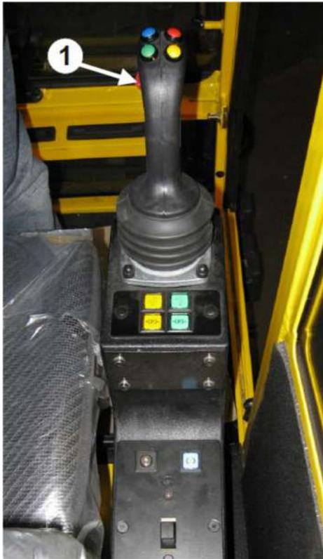
Con l'ausilio della regolazione del gas **1** viene regolato il numero di giri del motore diesel. Così è possibile una regolazione fine, dipendente dalla potenza, per tutti i movimenti di corsa e della gru.
