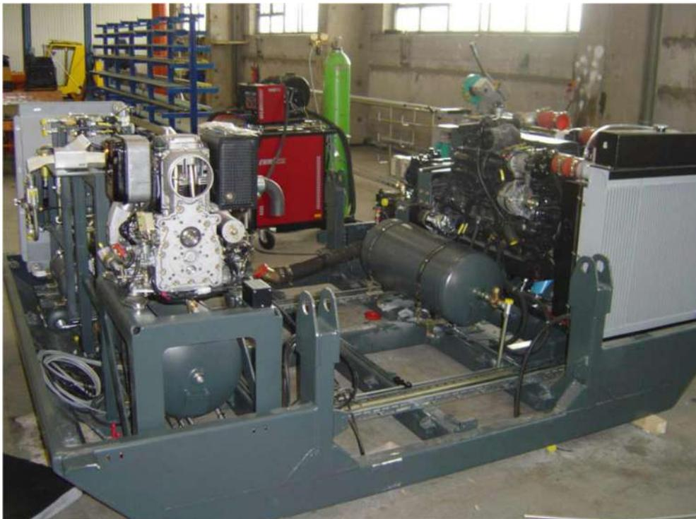
motore diesel può essere avviato sia dalla cabina che dalla cassetta di comando nel telaio. Il motore può essere arrestato anche mediante il radiotelecomando. Un circuito esclusivo con porte OR fa in modo che solo un pulsante di avvio possa avviare il motore diesel.
