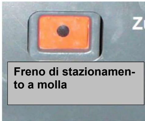
Controllo del freno di stazionamento a molla serrato
