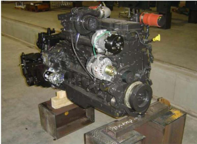
La forza motrice della KRC 100 FFS è un motore diesel a 6 cilindri raffreddato ad acqua con turbocompressore dei gas di scarico con raffreddamento dell'aria di alimentazione. Questo aggregato dispone di una potenza di 172 kW a 1600 U/min. Mediante elementi di conversione e di trasmissione, la potenza erogata raggiunge le pompe idrauliche regolabili. Mediante un comando proprio, il motore diesel fornisce al comando della gru informazioni importanti di esercizio e dia-
