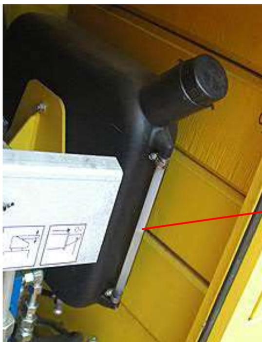
Indicatore di livello del serbatoio del riscaldamento
