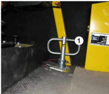
Bloccare e assicurare il perno di bloccaggio **1** per la sovrastruttura.
