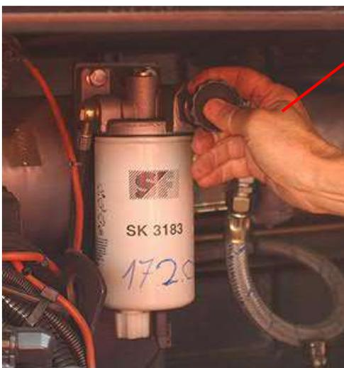
Riempire con combustibile l'impianto di alimentazione del combustibile stesso mediante movimenti della pompa finché l'impianto è sfiato
