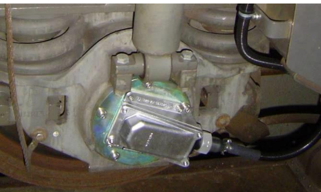
Am843 E2W: Geber für ETCS (Achse 2 links und Achse 3 rechts)
