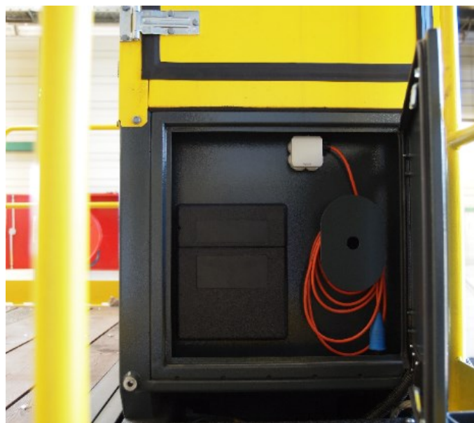
Fig. 2-24 Externe Speisung für Batterieladung des Energiemoduls
