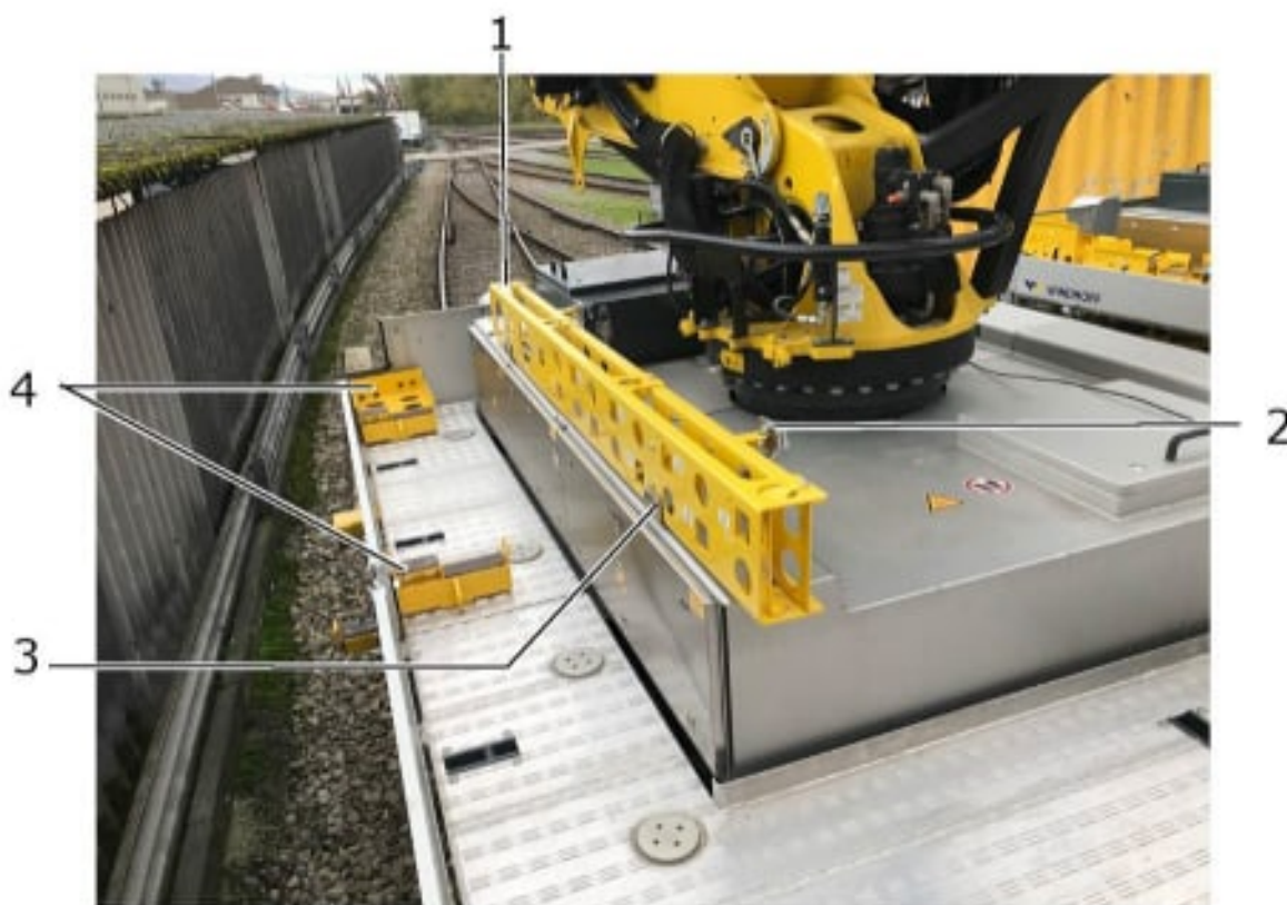
Abb. 133:Transportvorrichtung abgelegt und gesichert
