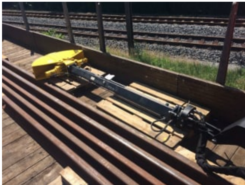
Abb. 5: Greifer mit Grabverlängerung auf Flachwagen
