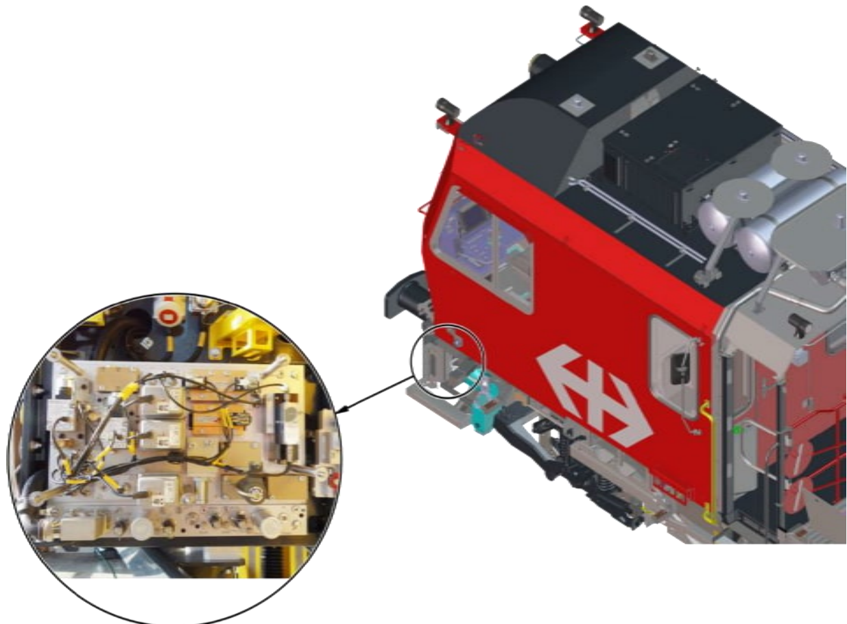
Abb. 49: Führerbremssventiltafel (Schutzhaube abgenommen)
