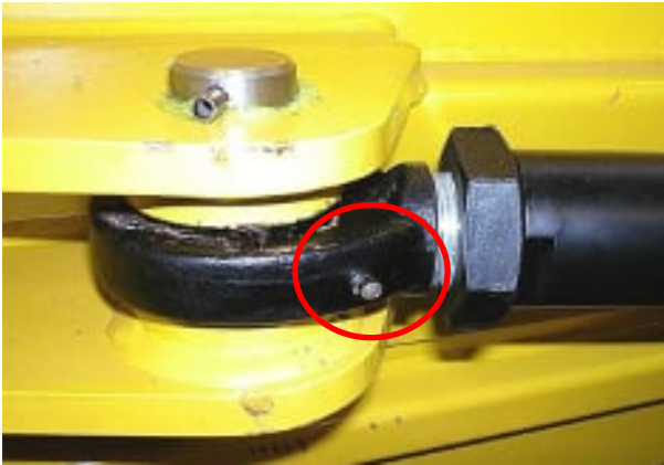
Abb. 16: Schwenkzylinder Flügel Frontpflug links und rechts
