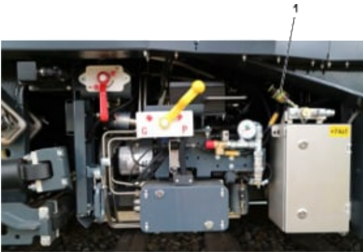
Abb. 20: Verschmutzungsanzeige Luftfilter (M2)
