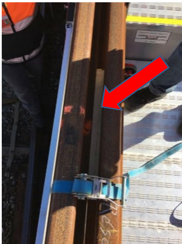
Abb. 131: Ladungssicherung bei Ladelücken
