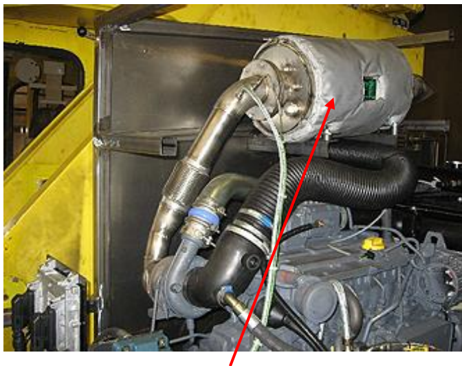
Neue Partikelfilteranlage (passives System, selbstreinigend)
