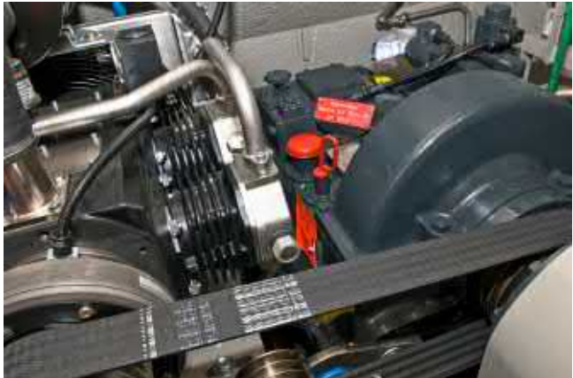
Grafik 2-4 Kontrolle Ölstand Turbogetriebe
