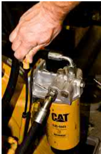
Grafik 2-1 Kontrolle Ölstand Dieselmotor
