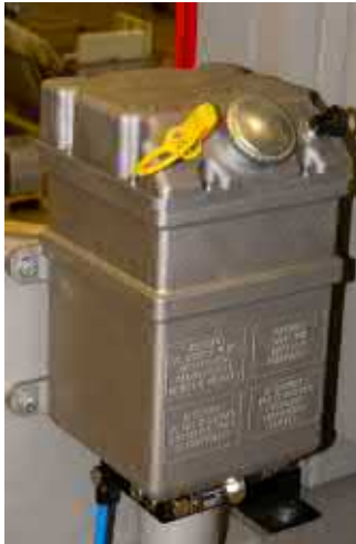
Grafik 2-2 Kontrolle Spurkranzschmierung
