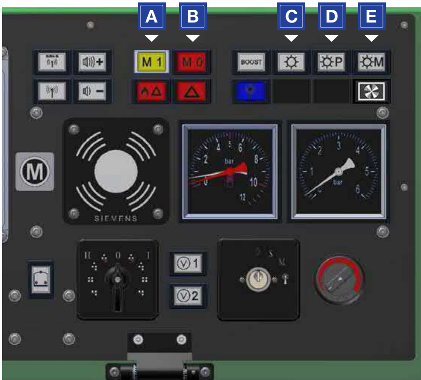
Grafik 1-12 Hauptkonsole Tmf 232 – Bedienungs- und Anzeigeelemente auf der Pulttafel rechts
