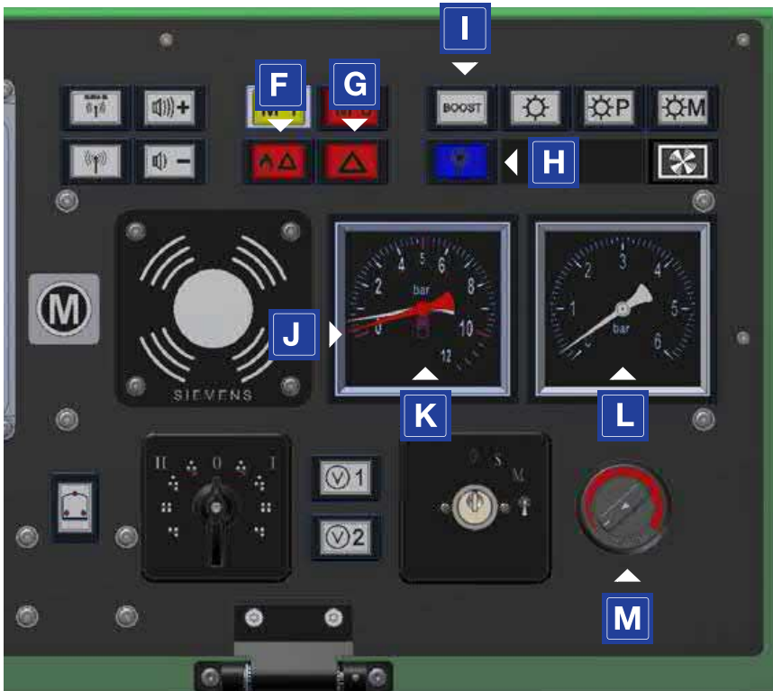
Grafik 1-15 Hauptkonsole Tmf 232 – Bedienungs- und Anzeigeelemente auf der Pulttafel rechts
