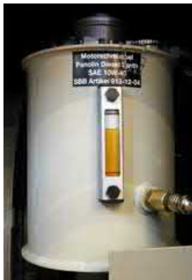
Grafik 1-30 Ölbehälter mit Schauglas für Lüfterantrieb
