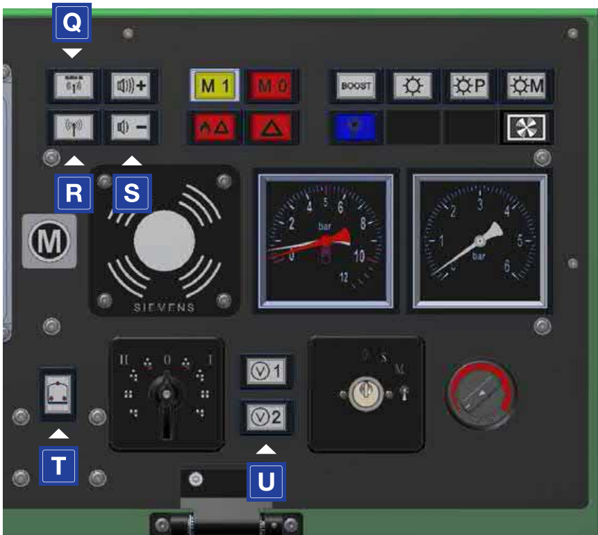
Grafik 1-18 Hauptkonsole Tmf 232 – Bedienungs- und Anzeigeelemente auf der Pulttafel rechts
