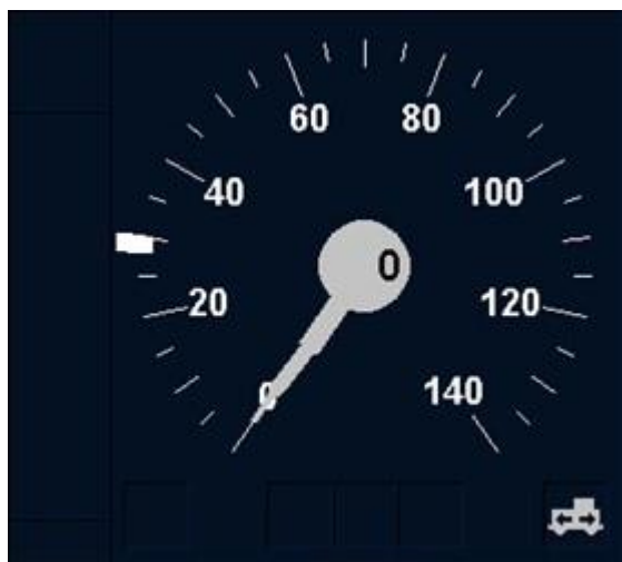
Bild 71 Anzeige der überwachten Geschwindigkeit im ETCS-Mode <Rangieren (SH)>
