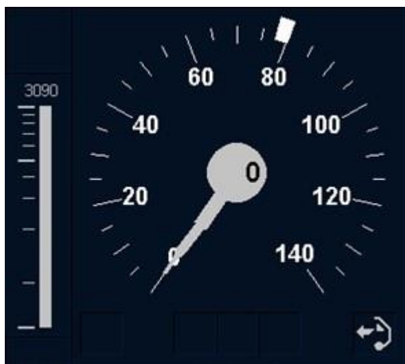
Bild 72 Anzeige der überwachten Geschwindigkeit im ETCS-Mode <Reversing>
