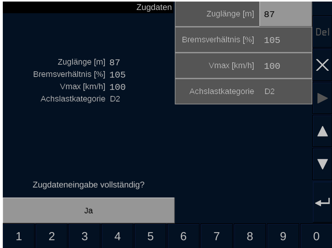
Bild 13 Sicherungstechnische Dateneingabe am Beispiel der Zugdaten
