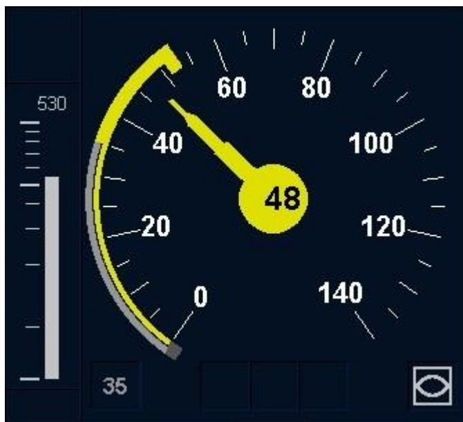
Bild 74 Anzeige der Release Speed (35 km/h)
