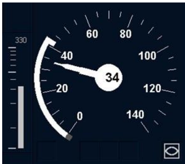
Bild 73 Anzeige der Zielentfernung (330 m) im ETCS-Mode <Full Supervision>
