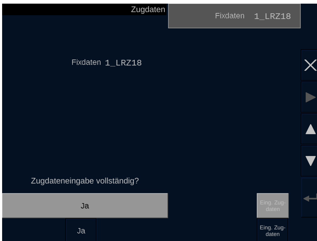
Bild 20 Eingabe der ETCS-Zugdaten – Eingabemodus Typ (Beispiel mit Fixdaten für LRZ18)
