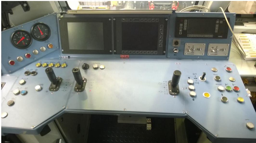
Bild 2 Führerstand Baudiensttraktor (Beispiel)
