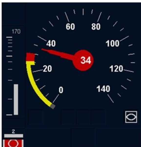
Bild 68 Bremseingriff durch die ETCS-Fahrzeugeinrichtung
