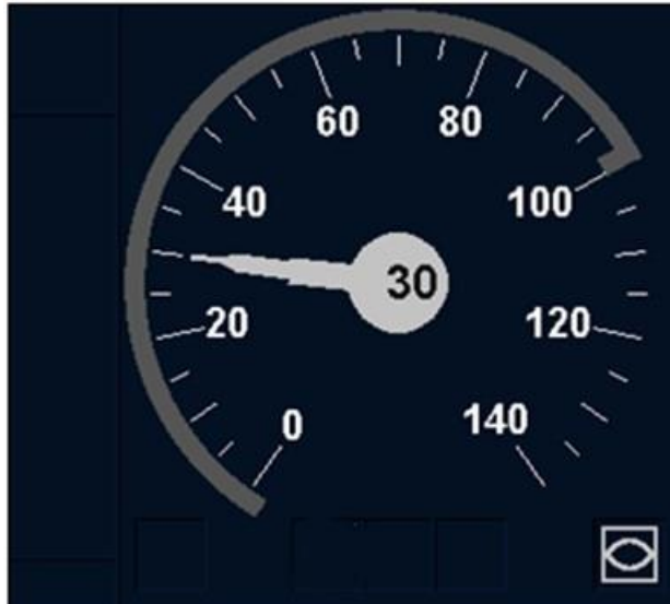
Bild 64 Anzeige der überwachten Geschwindigkeit (Normalbereich)
