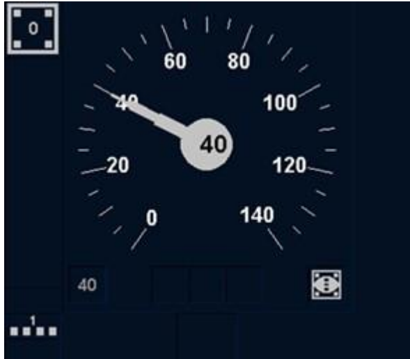
Bild 70 Anzeige der niedrigsten Überwachungsgeschwindigkeit (50 km/h) im ETCS-Mode <Limited Supervision>
