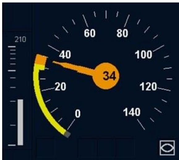
Bild 67 Überschreiten der überwachten Geschwindigkeit entlang der Bremskurve
