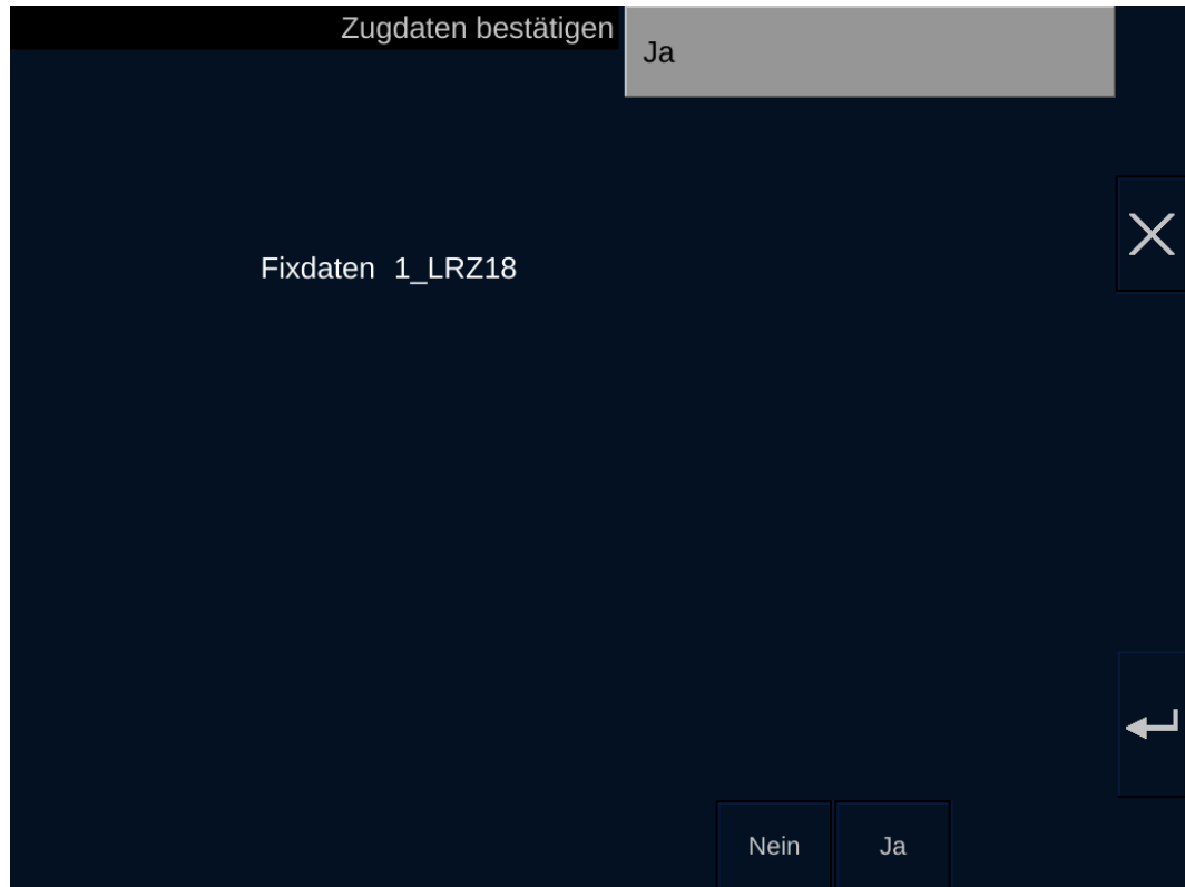
Bild 22 Validierung der ETCS-Zugdaten - Eingabemodus Typ ((Beispiel mit Fixdaten für LRZ18))
