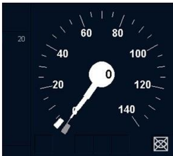
Bild 69 Anzeige von überwachter Geschwindigkeit und Zielgeschwindigkeit im ETCS-Mode <Staff Responsible>
