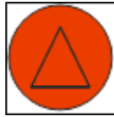
Leuchtmelder erhebliche Störung (79)
