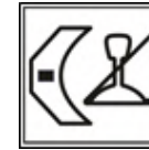
Leuchtmelder Notbedienung automatische Bremse (81)
