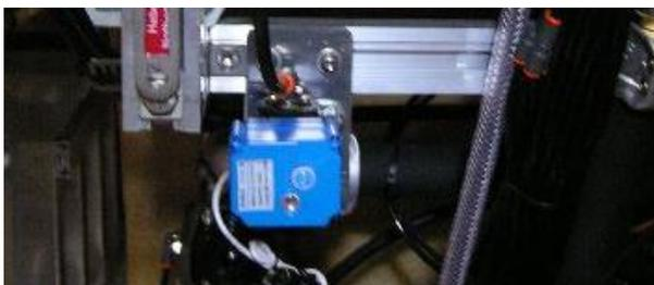
Im Störfall, wenn der Pneumatikdruck nicht aufgebaut wird, kann dieses Pneumatik-Hauptventil manuell geöffnet werden.
