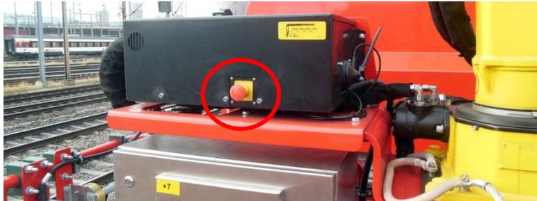
Die NOT-AUS-Schlagtaster bringen in einer Gefahrensituation alle Kranfunktionen innerhalb von 0,5 Sekunden zum Stillstand.
