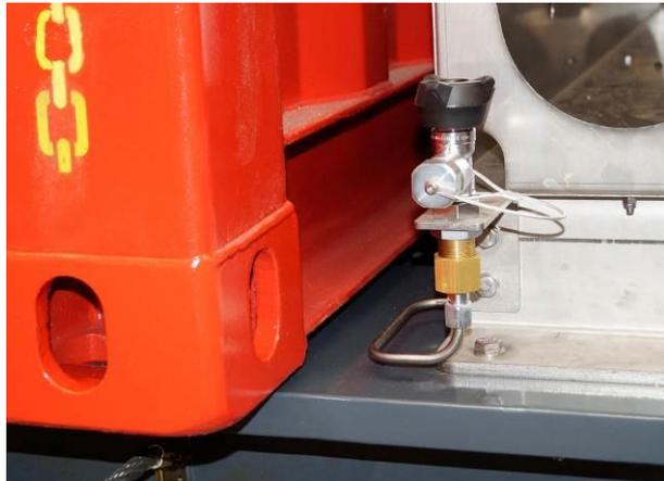
**Abb. 3 Füllanschluss Unterwagen**
