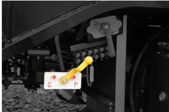
**Bremsartwechsel (G – P-Wechsel)**
