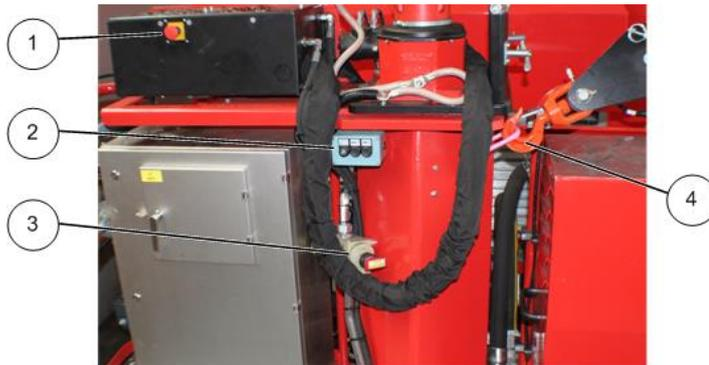
Schlüsselschalter und Transportposition des Ladekrans
