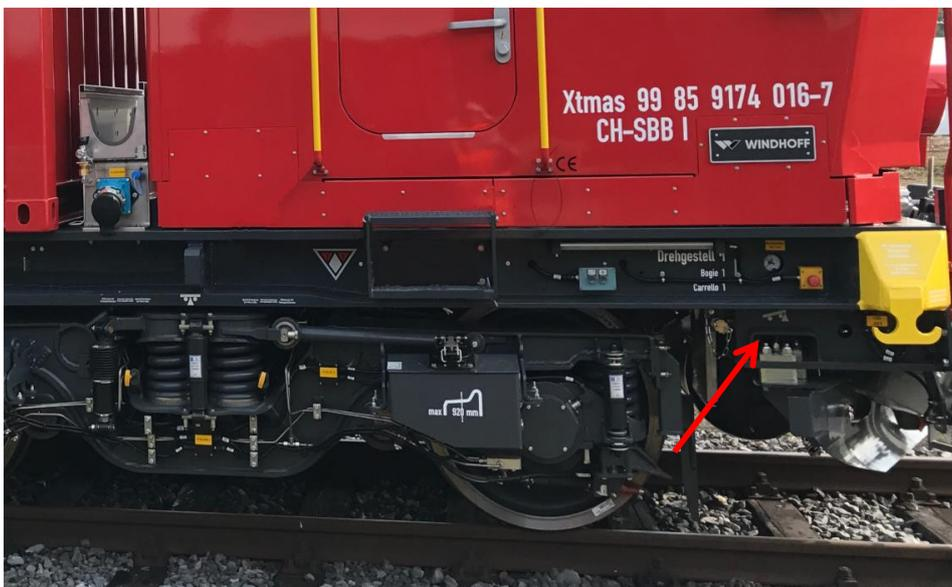
Die maximale Höhe zum einseitigen Anheben darf den Winkel von 2,5° nicht überschreiten. Vorausgesetzt ist hier, dass das zweite Drehgestell weiterhin auf den Schienen steht.
