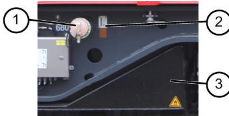
**Kraftstoffanzeige und -einfüllöffnung (hier: linke Fahrzeugseite)**
