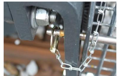
Rangierklapptritt in Normalposition, in hochgeklappter Stellung, Sicherung der Riegelstange
