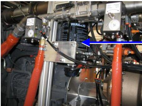
Luftrockner/-filter mit eingebauter Elektro-Heizung
