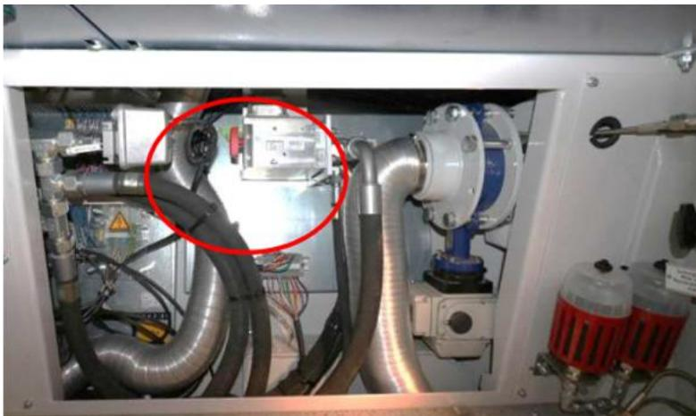
SiFa-/ETCS-Bremswirkventil im Führertisch rechts
