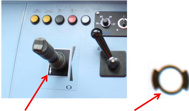
**Fahr-Bremsschalter, Symbol der Schnellbremsstellung**
