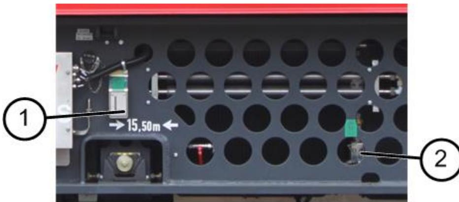
Kühlmittelanzeige und –einfüllöffnung
