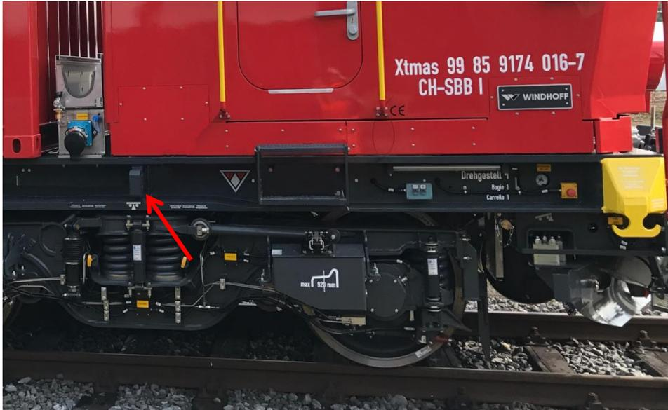
Bei einer Entgleisung in unzugänglichem Gelände für einen Kran, ist ein mobiles Aufgleissystem z.B. von Fa. Lukas zur Eingleisung zu verwenden. Hierfür sind zwei weitere Anhebepunkte hinter den Stirnplatten angebracht.
