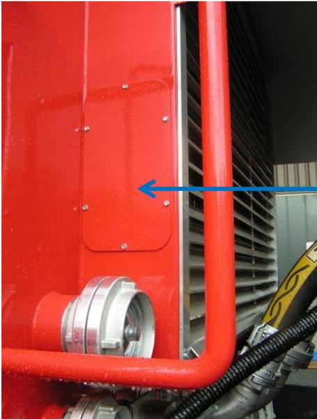
Wartungsdeckel des Lüftungsklappenmotors
