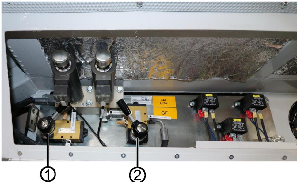
Absperrhähne Luftversorgung Makrofone (über Führerpult)
