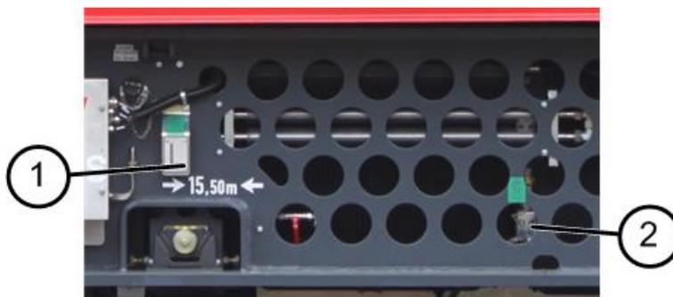
**Kühlflüssigkeitsanzeige und –einfüllöffnung**
