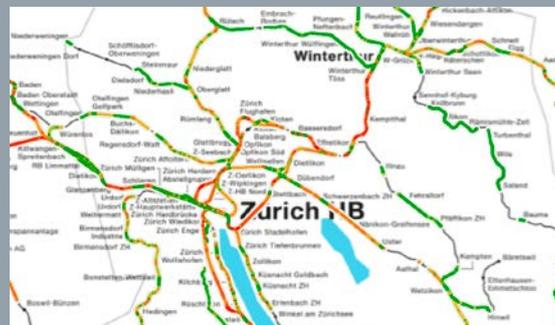
Die netzweite Head-Check-Prognose der SBB basiert auf realen Fahrzeugbewegungsdaten aus Anabel. Im Datenlabor wurde der Prototyp entwickelt und die Ergebnisse mit den Anlagenverantwortlichen verifiziert. In einem dritten Schritt erfolgt die Implementierung in ein produktives Tool.
